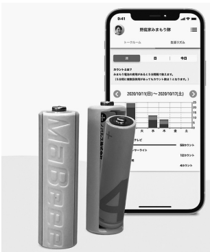
▶単三電池サイズの専用ケースに単四電池を入れて使用
